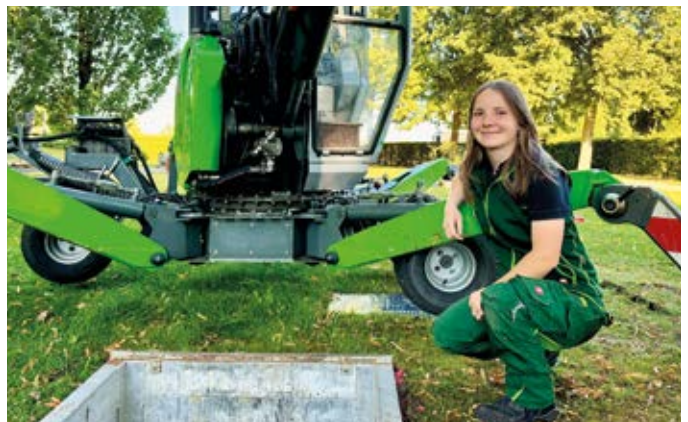
Friedhofsgärtnerin Lea Barczyk kniet neben einem offenen Grab, das sie gerade mit einem speziellen Friedhofsbagger ausgehoben hat. Die Verschalung sorgt dafür, dass die Seitenwände nicht einstürzen.
